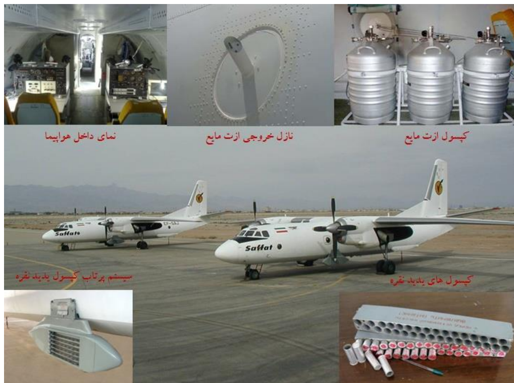
شکل ۴: هواپیمای باروری و تجهیزات و سنسورهای سنجش پارامترهای هواشناسی که بر روی هواپیما نصب شده است
