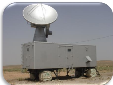
شکل ۱۸: تصویری از آنتن فرستنده و گیرنده امواج رادار و اتاقک محتوی تجهیزات مربوطه
