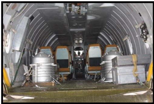
شکل ۲: نمای درونی هواپیمای باروری در ایران: درب گسترده عقب هواپیما باز شده و تجهیزات به درون آن انتقال می‌یابد
