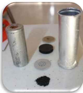
شکل ۹: گلوله‌های حاوی یدیدنقره. ماده یدیدنقره در ترکیب با مواد قابل احتراق که در محفظه‌های آلومینیومی جای گرفته و به صورت گلوله‌های پرتابی آماده می‌شود.
