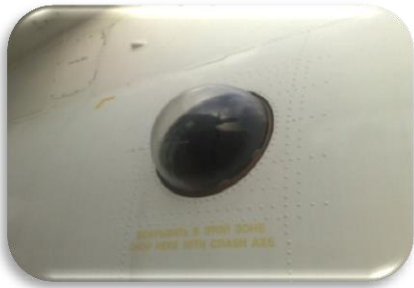
شکل ۸: شیشه بلیستر جهت مشاهده چشمی میزان یخ و آب در ابر و پدیده‌های نوری توسط هواشناس درون هواپیما
