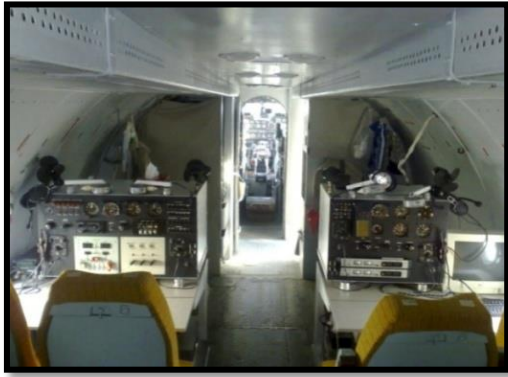
شکل ۳: نمای دیگر درونی هواپیمای باروری در ایران. تصویری از تجهیزات ثبت داده‌های حاصل از سنجنده‌ها و نیز دستگاه دستور پرتاب پیروپاترون‌های یدیدنقره از درون هواپیما
